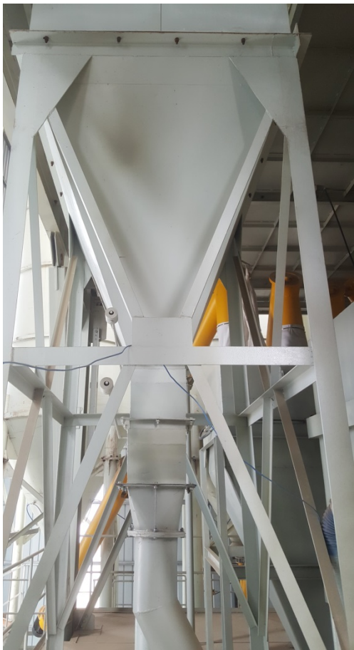
包装机散装机配套袋式除尘器
